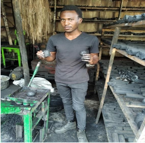
Actual production of briquettes
